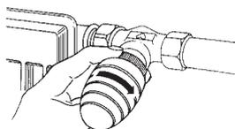
3. Handantrieb bzw. Überwurfmutter bei Handantrieb „D“ mittels Werk-zeug mäßig festziehen.
